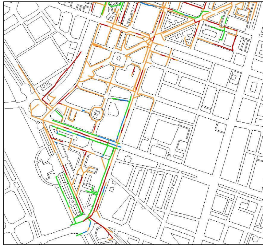
Figura 2. Estados de sobrecarga en la red actual. Zona sur de actuación.
